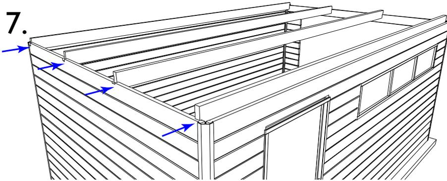
**NL: Plaatsing van de dakbalken:** Plaats de dakbalken P2 in de uitsparingen van de dakhellingen. Vijs elke dakbalk vast **door** de helling met 1 vijs van 70mm per kant.
