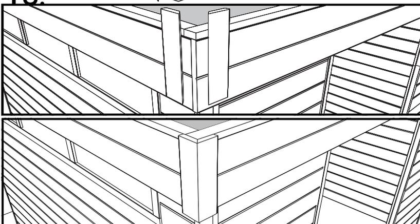
**NL:** Om de aansluiting van de frontale sierlatten FSLM te maskeren, maakt u een hoekprofiel dmv 2 hoeksierlatten HSL. Gebruik 2x2 vijzen van 25 mm om deze te bevestigen op de FSLM. Plaats ten slotte nog een latje SSL daar waar de 2 voorste latten FSLM samen komen.
