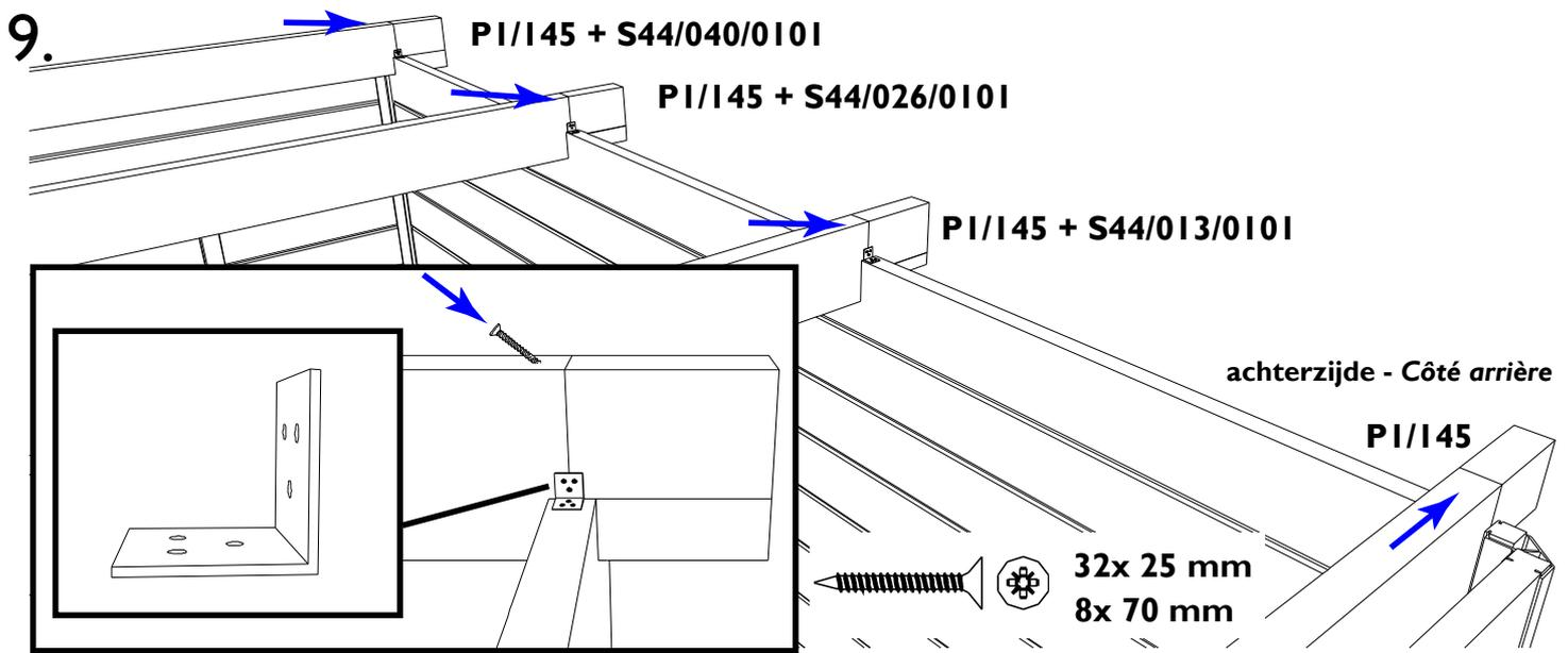
**NL: Montage van de hulpdakbalkjes:** plaats de **kortste** hulpdakbalkjes P1/I45 tegen de uiteindes van de dakbalken P2 met de blokjes S44 aan de **onderzijde**, het balkje met het hoogste blokje S44 aan de voorzijde, het balkje zonder blokje aan de achterzijde (zie tekening). De bovenkant van de hulpdakbalkjes P1 komt gelijk met de bovenkant van de balken P2. Bevestig aan de dakbalk dmv een hoekijzer (vijsjes van 25mm) en een steekvijs van 70mm aan de bovenkant (zie detail tekening).
