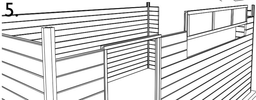
**NL:** Bouw verder op tot u ter hoogte van de onderkant van het raam komt. Plaats de delen **M1** en **D2**. Laat het raam in de opening zakken. Boven de deurkader en het raam dient u de plank **M6** te plaatsen. Zaag eerst uit tot op de sleuf. Het uitgezaagde deel komt boven de deurkader. Zaag volgens volgende maten: **1ste** zaagsnede op **550mm**, **2de** zaagsnede op **1450mm** van het begin van de plank. **Opgelet!** Zaag uit van de **groef** (onderkant plank) naar de sleuf!!
