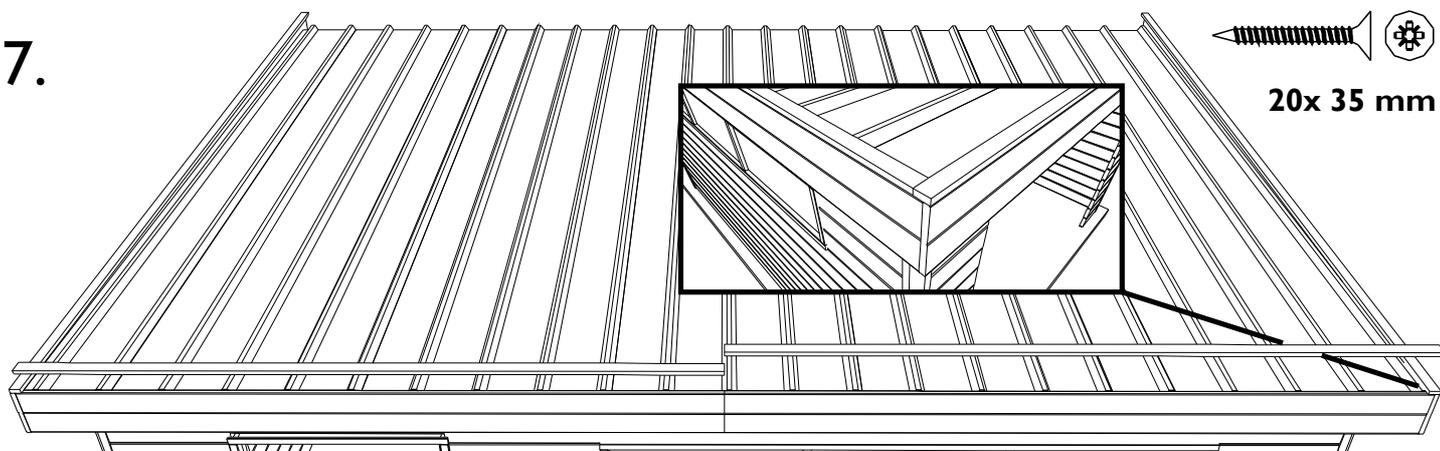
**NL: Afwerkingslatten op het dak:** vijs de latten SSL boven op de frontale sierlatten FSLM. Begin met de zijkanten en plaats dan de latten aan de voorkant. De latten SSL dienen nog op lengte gezaagd te worden. Gebruik 5 vijzen van 35mm per lat.
