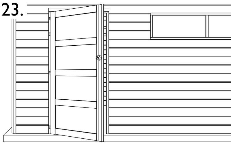
**NL:** Plaats binnen én buiten de sierlat SRD bovenop de kader van de deur. Zij dient om de opening bovenaan te verbergen tijdens het werken van het hout. Zet vast met vijzen van 25 mm **op de deurkader**. Bevestig zeker niet aan de wandplanken!
