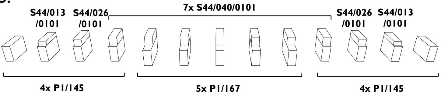
**NL: Voorbereiding van de HULPdakbalken:** Vijs de latjes S44 op de hulpdakbalkjes PI (**opgelet 2 verschillende lengtes**) volgens bovenstaand schema. Deze latjes zitten aan **1 kant gelijk met het uiteinde** van het hulpbalkje PI. Gebruik vijzen van 35mm per latje S44 van 13 en 26mm dikte en een vijs van 70mm voor de latjes S44 van 40mm dik. Vergeet de latjes S44 niet voor te boren!
